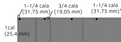
Pozycja śrub z odstępem 12 cali (304 mm) między środkami Szczegółowy widok Rysunku 3c
