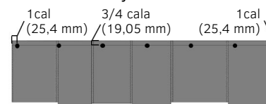
Pozycja gwoździ z odstępem 8 cali (204 mm) między środkami Widok szczegółowy Rysunek 4d
