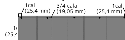
Pozycja śrub z odstępem 12 cali (304 mm) między środkami Szczegółowy widok Rysunku 4c
